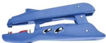
Tipo combinato. Per togliere automaticamente il rivestimento isolante di fili conduttori e per fissare capicorda. Corpo in materiale sintetico rinforzato con fibra di vetro. Lame in acciaio. Lunghezza di spelatura mm 5. Tagliafilo incorporato.
